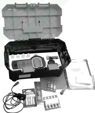
Рис. 2. Настольная почвенная лаборатория НПЛ и оборудование из её состава: а — укладка лаборатории; б — тест-комплекты; в цифровые весы, кондуктометр, почвенный термометр и пр.; г — сито почвенное; д — набор-укладка для фотоколориметрирования «Экотест-2020-К».
