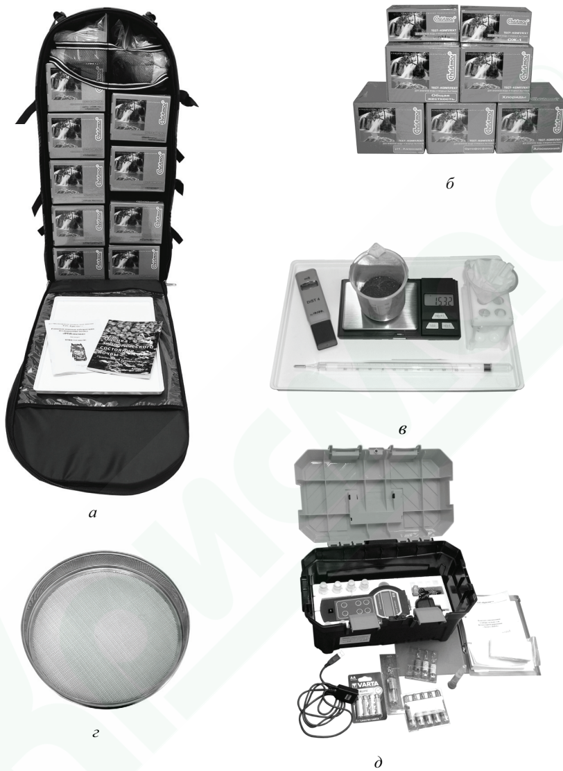
Рис. 1. Ранцевая почвенная лаборатория РПЛ и оборудование из её состава: а — ранцевая укладка; б — тест-комплекты; в — цифровые весы, кондуктометр, почвенный термометр и пр.; г — сито почвенное; д — набор-укладка для фотоколориметрирования «Экотест-2020-К».
