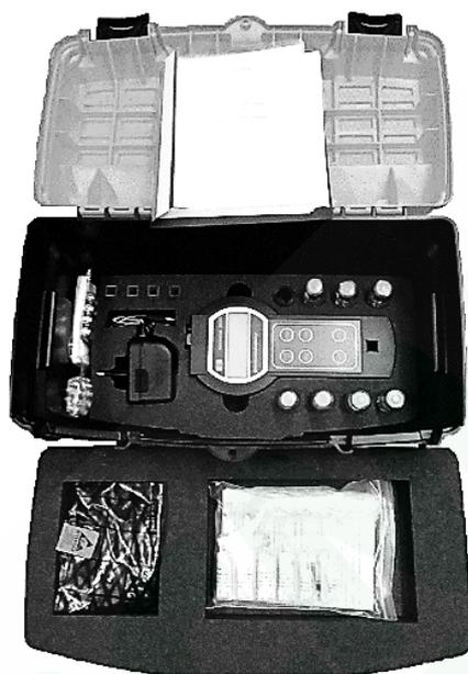
Рис. 8. Набор-укладка для фотоколориметрирования «Экотест-2020-К» в раскрытом виде
