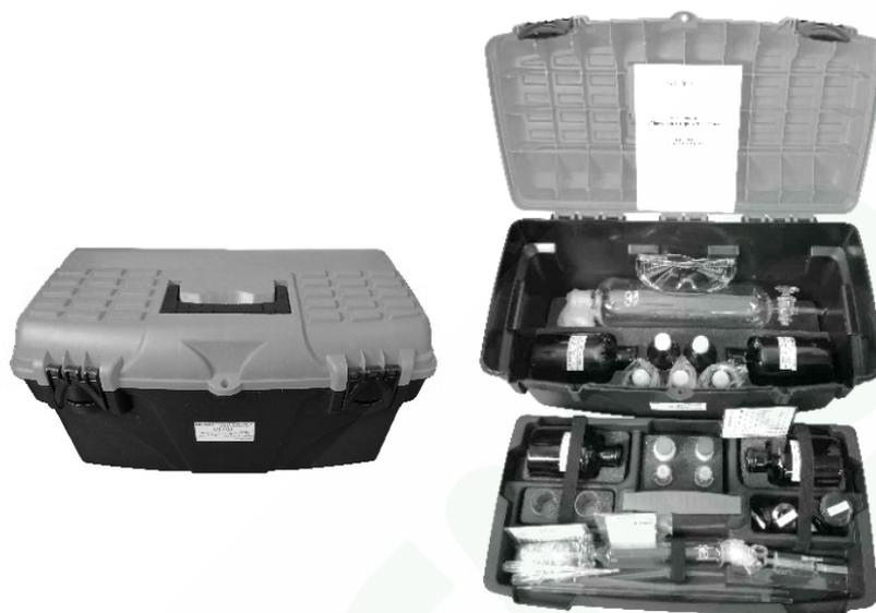
Рис. 4. Общий вид тест-комплекта «Масла и нефтепродукты в воде» в закрытом и раскрытом виде
