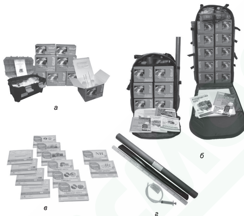
Рис. 5. Внешний вид некоторых тест-комплектов и тест-систем для анализа воды: а — тест-комплекты различного типа; б — тест-комплекты в составе ранцевой полевой лаборатории модели НКВ-Р; в — тест-системы; г — тест-комплект «Прозрачность и мутность»
