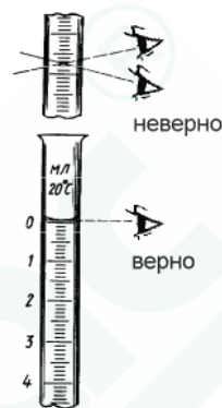
Рисунок 10. Наблюдение уровня жидкости (мениска) при титровании.
