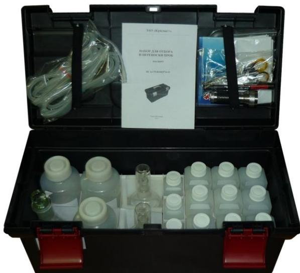
**Рисунок 3. Набор для переноски и хранения проб котловой воды.**
