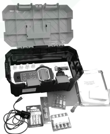
Рис. 1. Ранцевая почвенная лаборатория РПЛ и оборудование из её состава: a — ранцевая укладка; б — тест-комплекты; в — цифровые весы, кондуктометр, почвенный термометр и пр.; г — сито почвенное; д — набор-укладка для фотоколориметрирования «Экотест-2020-К».
