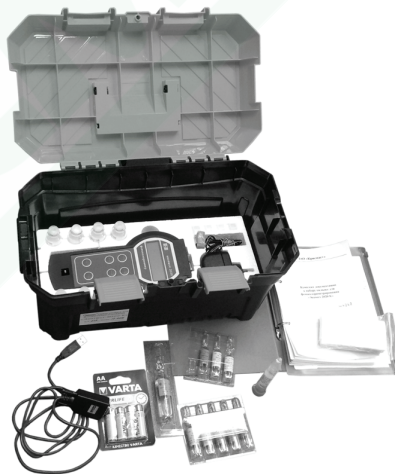
Рис. 2. Настольная почвенная лаборатория НПЛ и оборудование из её состава: a — укладка лаборатории; б — тест-комплекты; в цифровые весы, кондуктометр, почвенный термометр и пр.; г — сито почвенное; д — набор-укладка для фотоколориметрирования «Экотест-2020-К».
