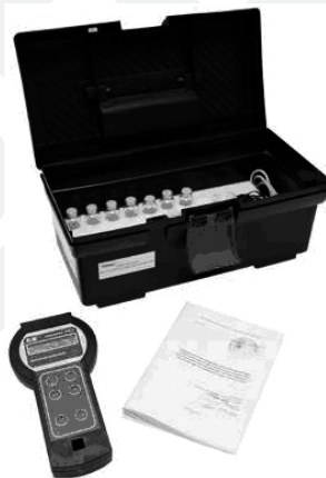
Рис. 1. Ранцевая полевая лаборатория РПЛ-почва и оборудование из её состава (базовый вариант):
