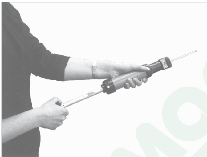
Рис. 5. Анализ воздуха с применением индикаторной трубки совместно с аспиратором НП-3М
